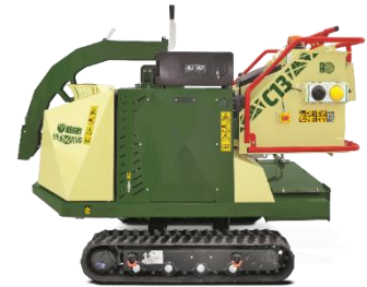
Uitwerppijp en invoertrechter inklapbaar voor transport
