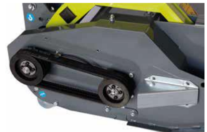
3 V-snaren Beveiliging V-snaardeksel
